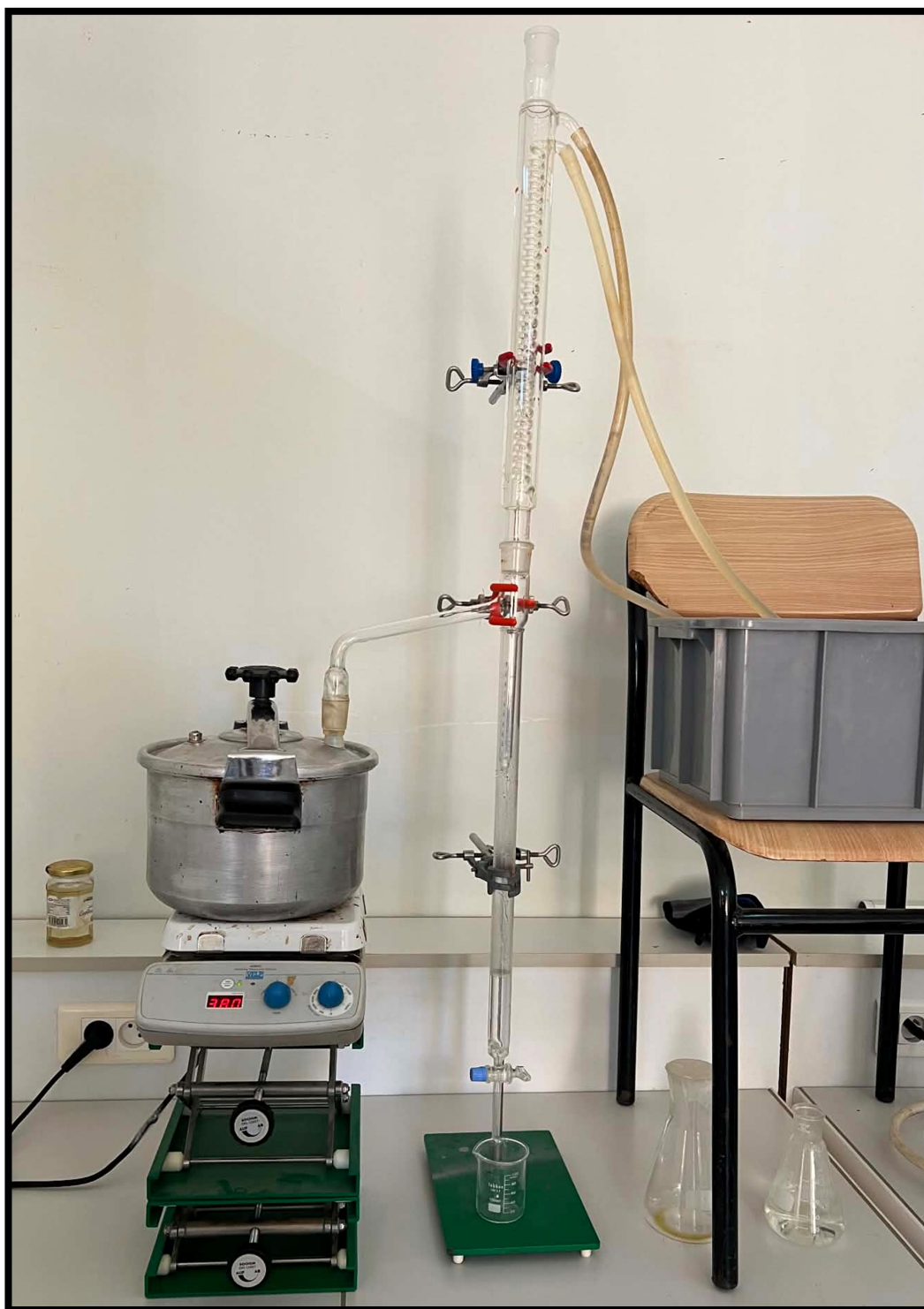
Figure 07: Le montage utilisé pour l'extraction d'huile essentielle ( hydrodistillation )
