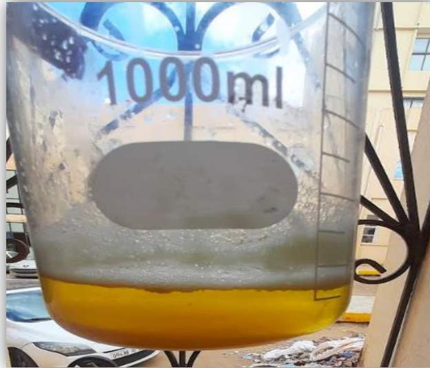
Figure II.5 : Image montrant l'apparence de deux phase : biodiesel en haut et la glycérine en bas.
