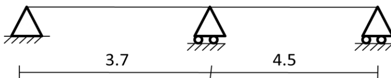
Figure 105: Schémas static de poutrelle type 5 étage courant
