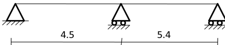
Figure 99: Schémas static de poutrelle type 6 terrasse
