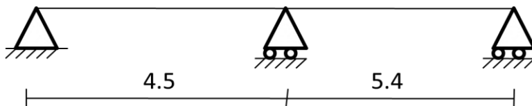
Figure 106: Schémas static de poutrelle type 6 étage courant
