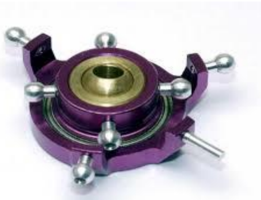
Figure 6 : Plateau cyclique d'un hélicoptère
