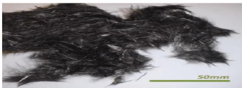
Figure I. 6: Fibres de carbones recyclées par pyrolyse sur lit fluidisé
