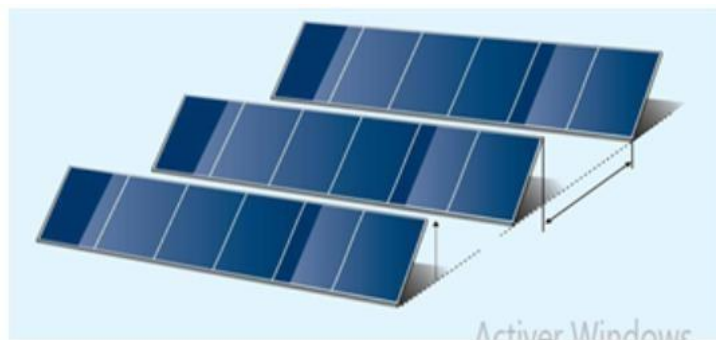
Figure (III.6) : Influence de l'ombrage sur les performances du module [66].
