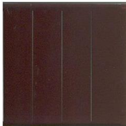
Figure (II.12) : Cellule en silicium amorphe [42].
