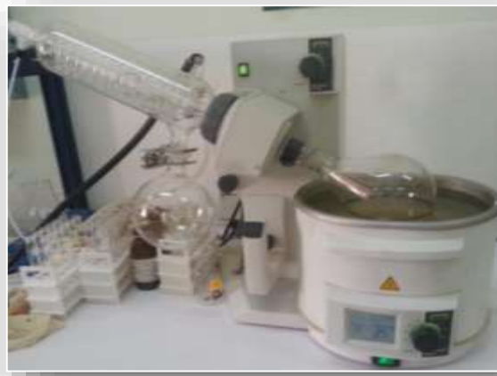
Figure 9: Evaporation de l'extrait éthanolique
