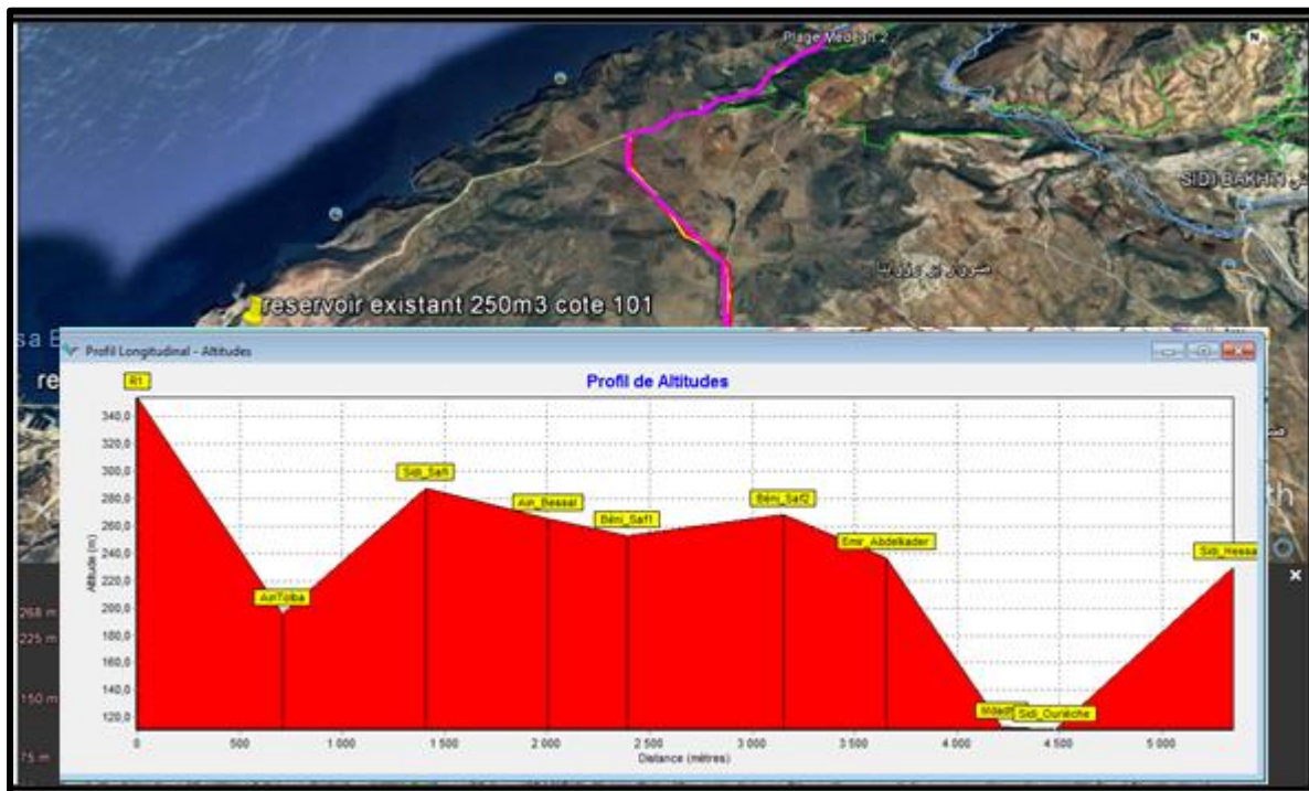
Figure 24 :Profil en long de l'adduction simulé par EPANET
