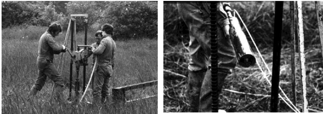
Figure 1.2 : Les débuts du pressiomètre autoforeur au LR de St Brieuc (Baguelin et al., 1978)
