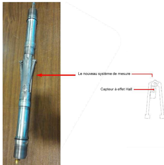
Figure 2.6 : Palpeur de mesure de la déformation et sa position sur la sonde (Aissaoui, 2021)
