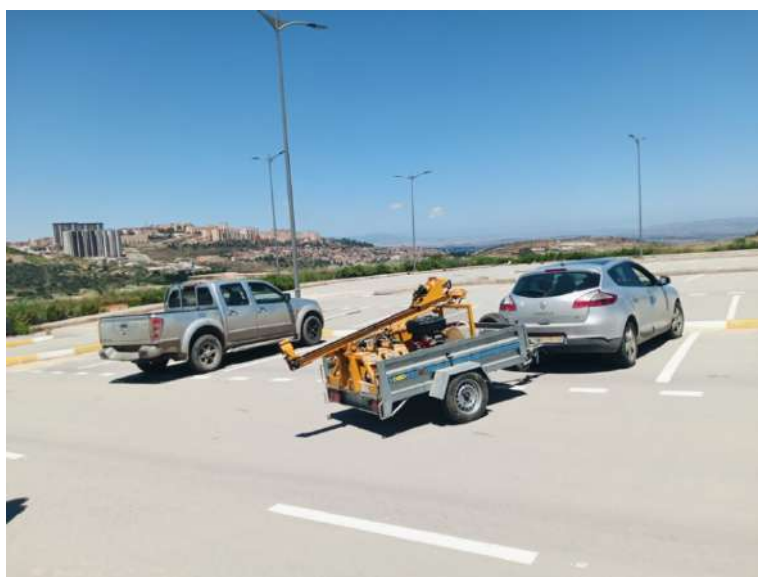
Figure 2.22 : Transport de la sondeuse Sedidrill S80 - Remorquage par véhicule de tourisme
