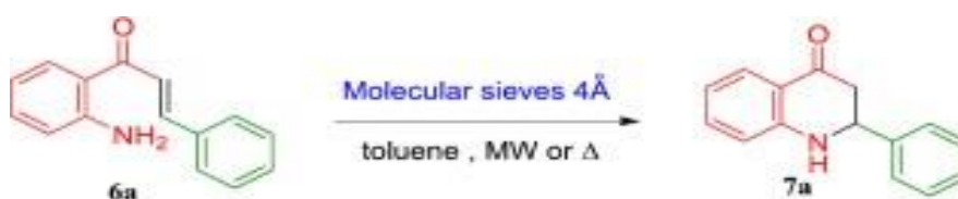
Schéma I.41. Optimisation des conditions de la réaction d'aza-Michael intramoléculaire de la 2-aminochalcone
