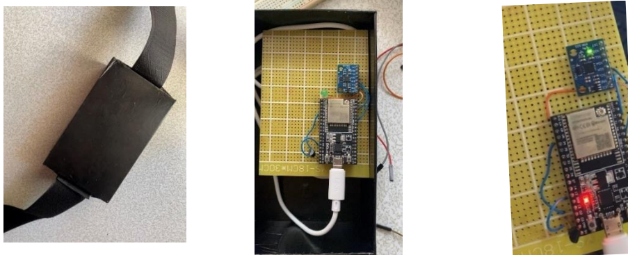
Figure II.1 : Collier BoviTrax fixé au cou du bovin avec vue détaillée de son architecture interne : capteurs, microcontrôleur et module d'alimentation intégrés.
