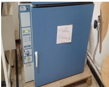
Figure 6 : Appareillage utilisé pour le calcul le taux d'humidité des grains de blé.
