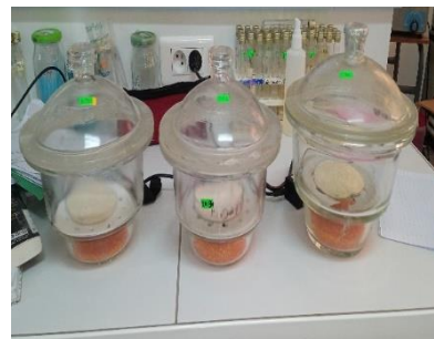
Figure 6 : Appareillage utilisé pour le calcul le taux d'humidité des grains de blé.
