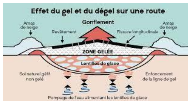
Figure 22: effet du gel et dégel sur la route [5].
