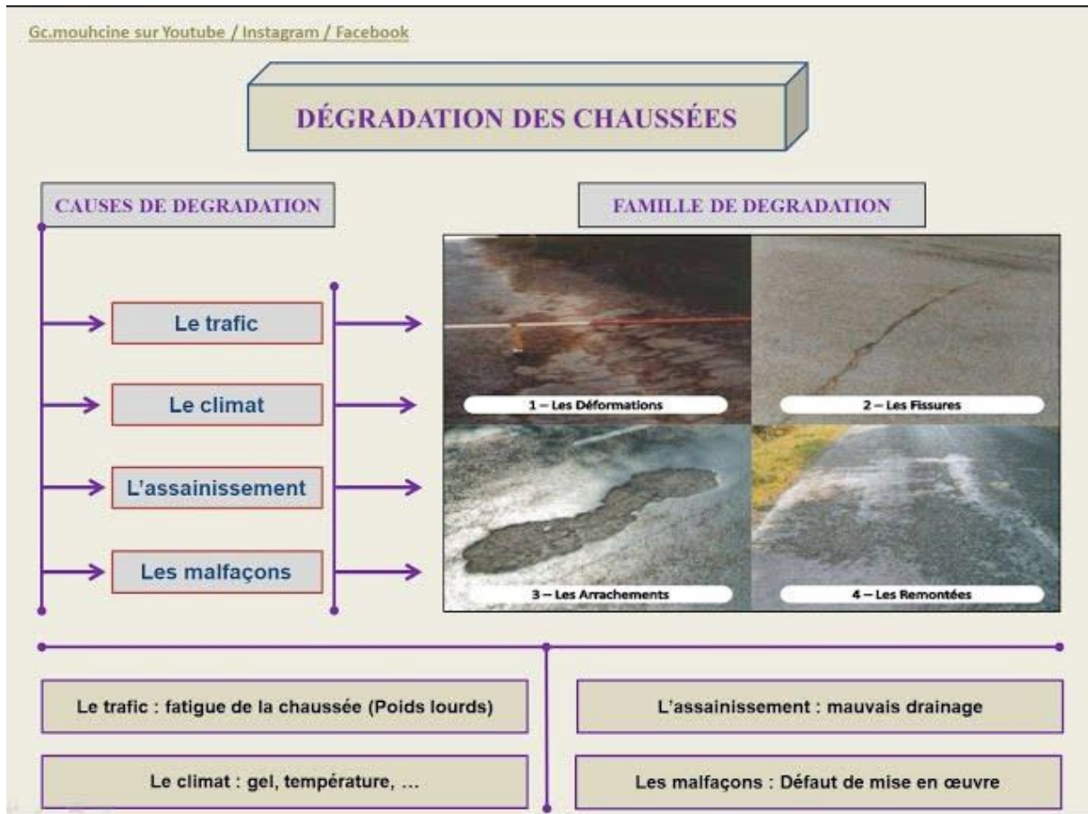
Figure 20: les majeures dégradations des routes[8].
