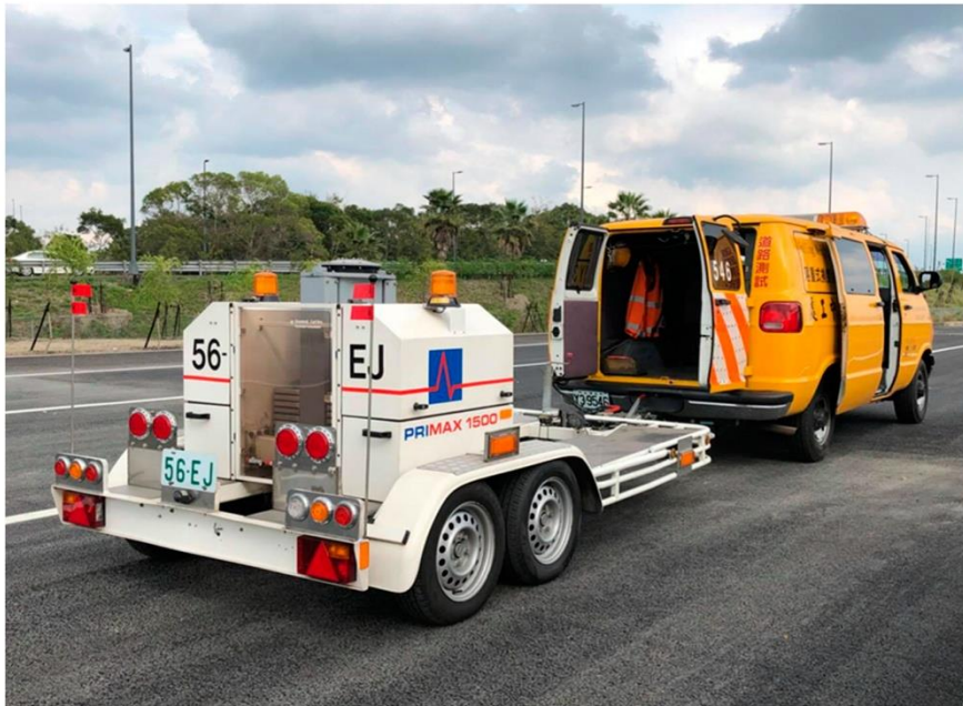
Figure 43: Appareil de Mesure de déflexion (F/HWD) [5].
