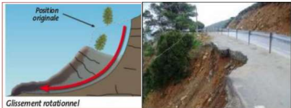
Figure 1.14 : Glissement rotationnels (Bouhchicha. & Doudou., pfe 2022. )
