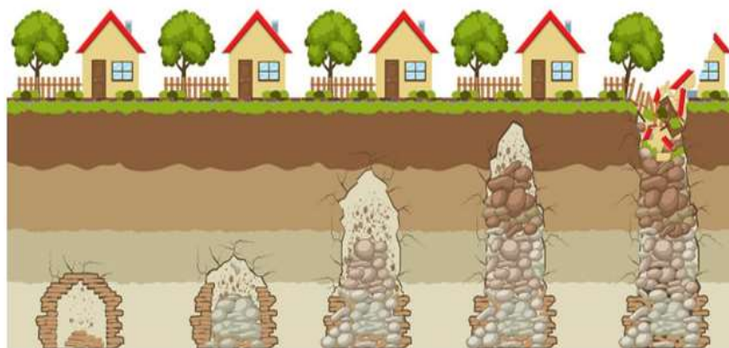
Figure 1.1 : progression d'un effondrement (GEODERIS, 2025)
