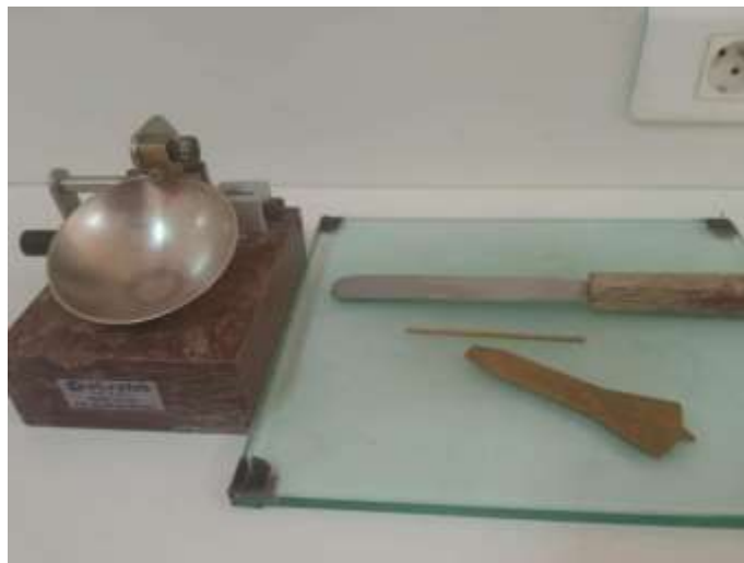
Figure 4.5 : Appareil de casa grande (Dahmane Ayad. & Mekaou., 2021)
