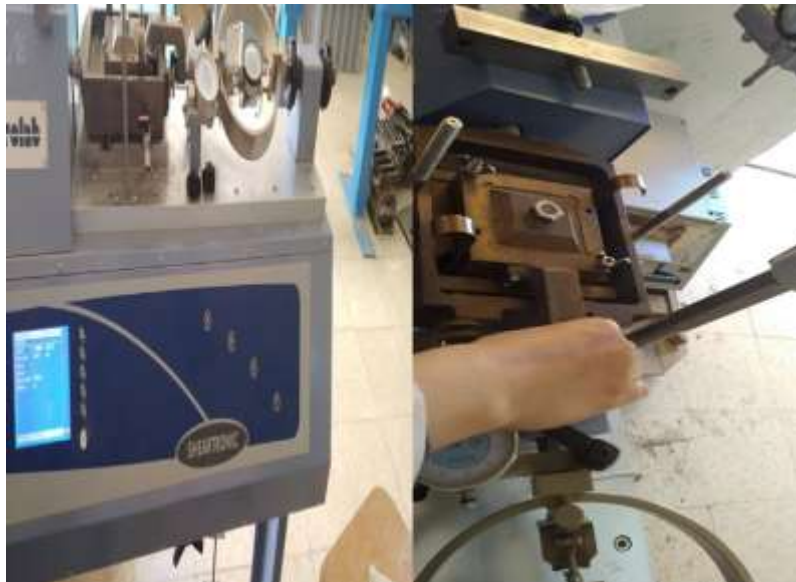
Figure 4.14 : Essai de cisaillement rectiligne à la boîte. (Dahmane Ayad. & Mekaou., 2021)
