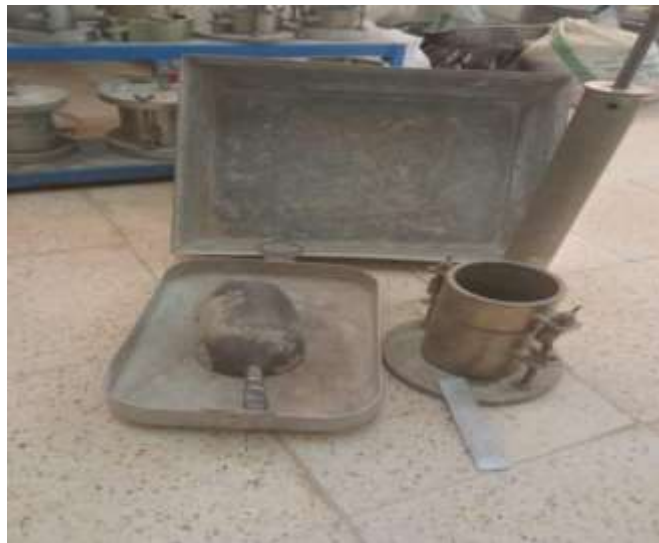
Figure 4.9 : Les équipements utiles pour l'essai Proctor au laboratoire (Dahmane Ayad. & Mekaou., 2021)
