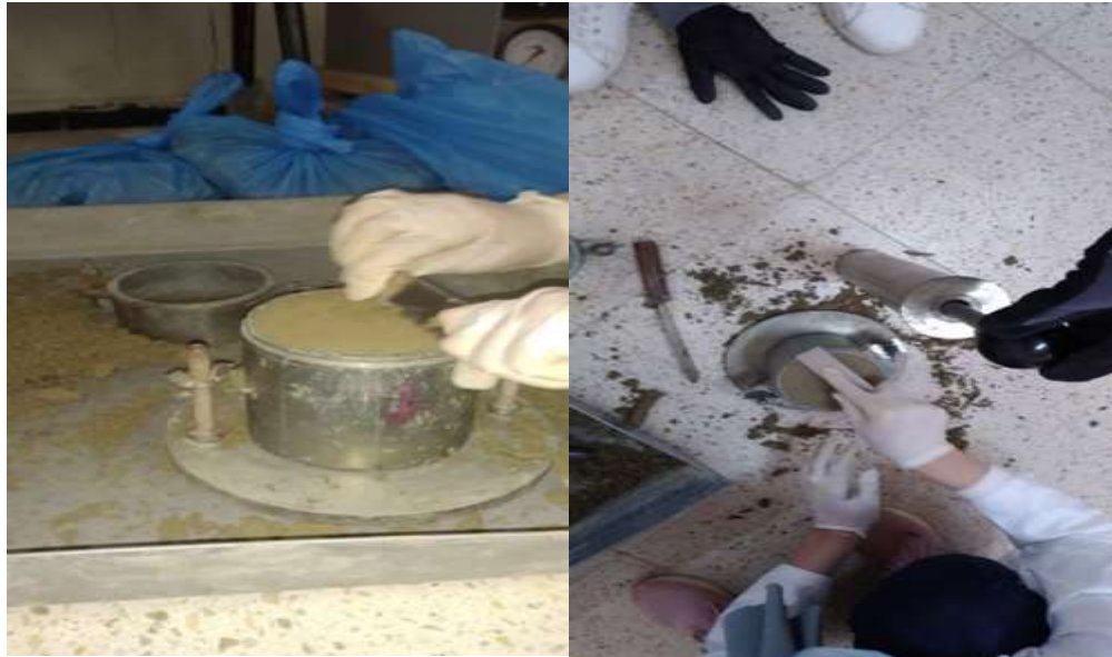
Figure 4.10 : L'essai de compactage (Proctor normale). (Dahmane Ayad. & Mekaou., 2021)
