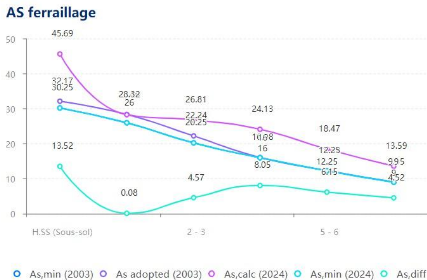
Figure 6.5. Ferrailage des éléments Renforcement CFRP
