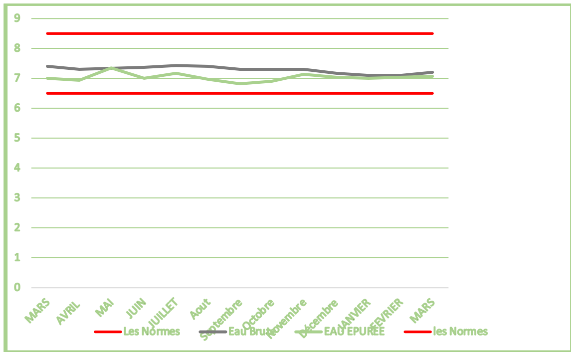
Figure 34:Variation mensuelle de PH (A l'entrée et a la sortie de la STEP)
