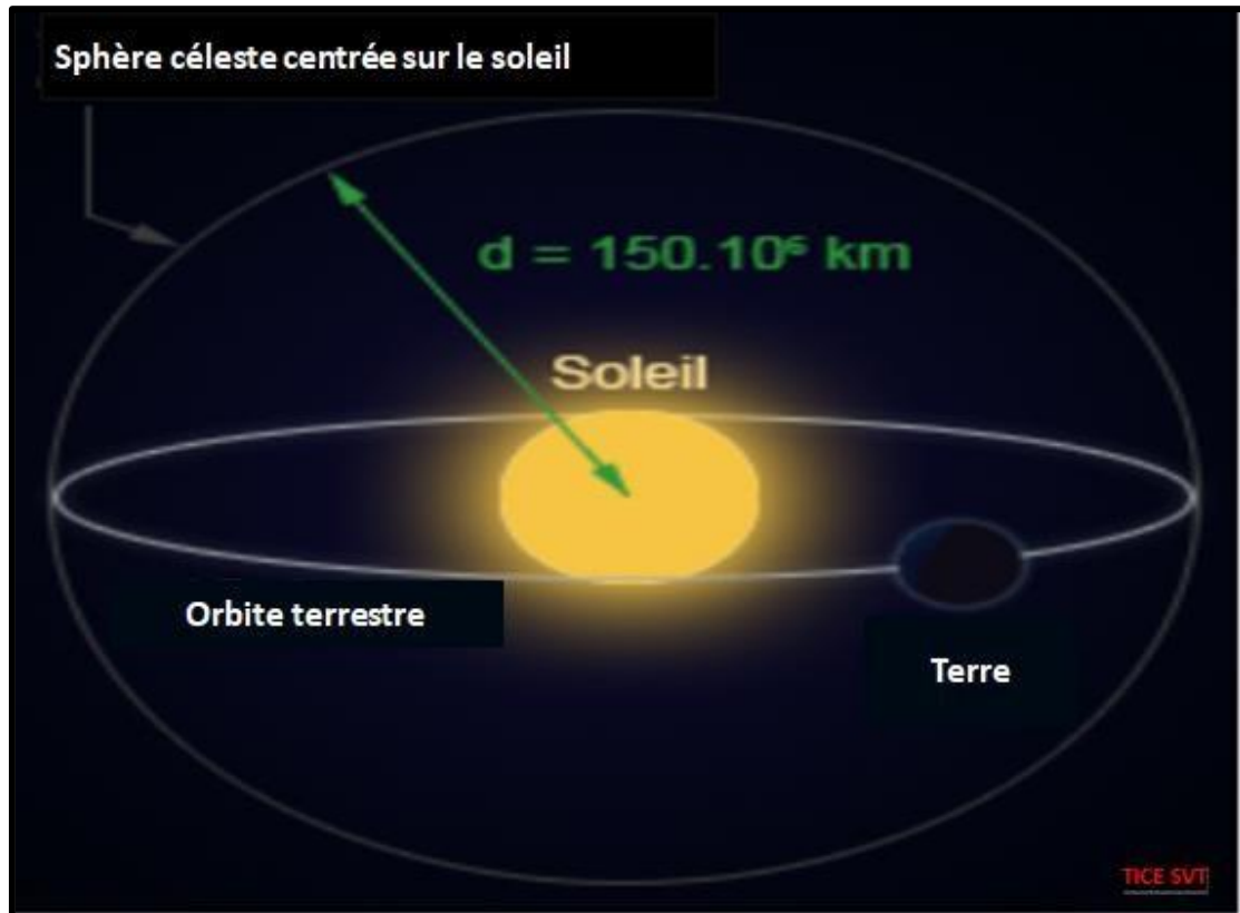
Figure I.6 : La sphère imaginaire (soleil-terre) sur laquelle la puissance solaire est répartie
