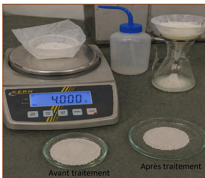
Figure II-5 : Mode opératoire de détermination de la perte de masse
