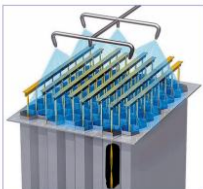
Figure I.12 : Schéma simplifié d'un précipitateur électrostatique humide [51]
