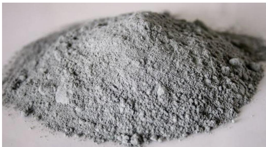
Figure II.2 : Photographie des microparticules de fumé de silice utilisé.
