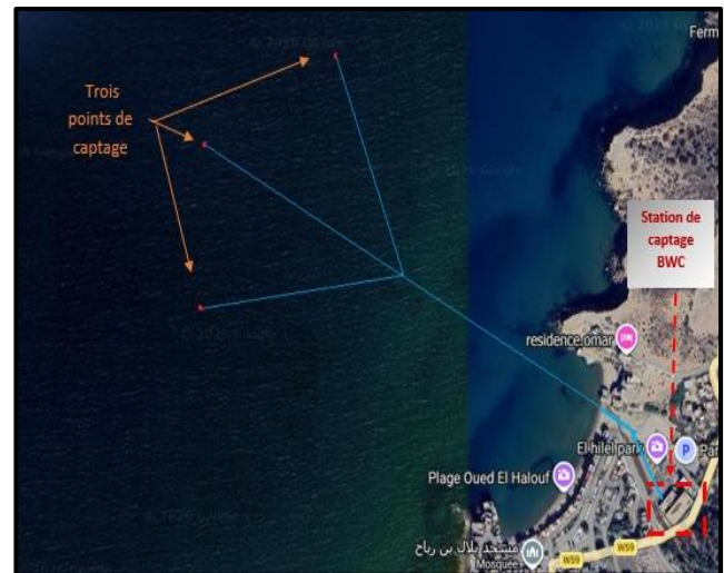
Figure 47: Schéma présenté les plusieurs points d'aspiration
