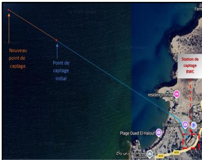
Figure 48: Schéma d'augmentation de la longueur de la conduite d'aspiration
