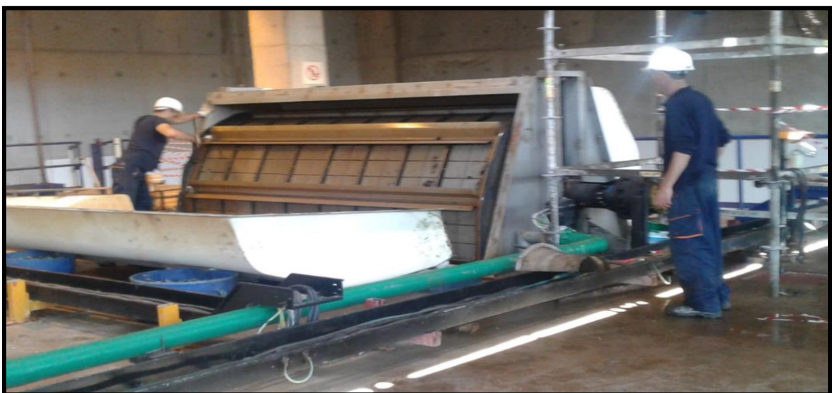
Figure 18: filtre rotatif (BWC)
