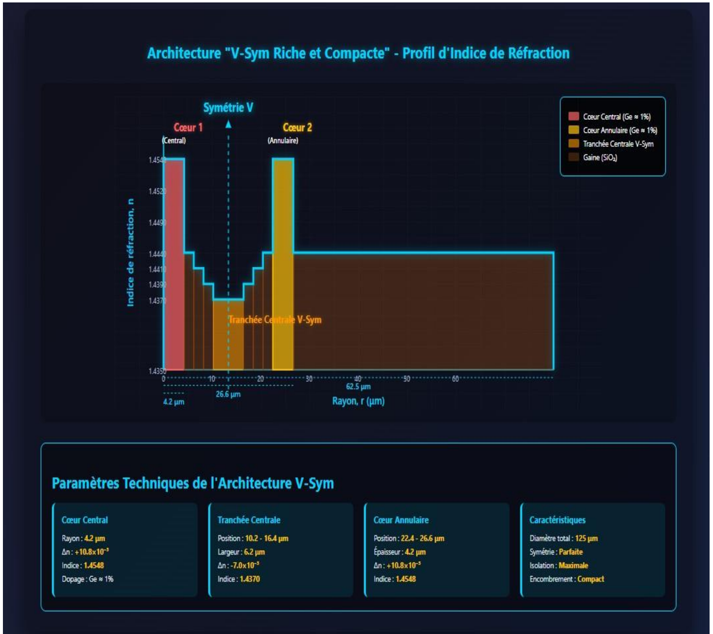
Figure 6 profil d'indice radial de cette structure V-Sym.
