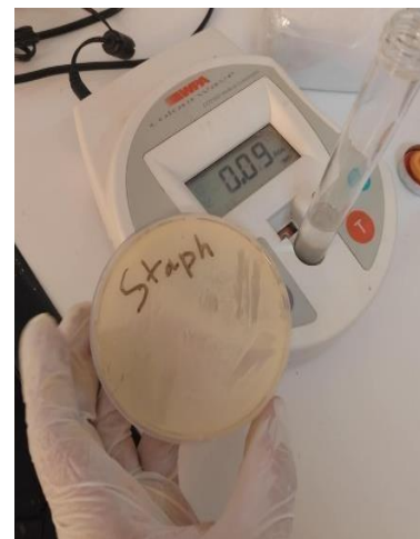
3-Vérifications de la turbidité à l'aide IMPLÉN OD600 DiluPhotometer.
