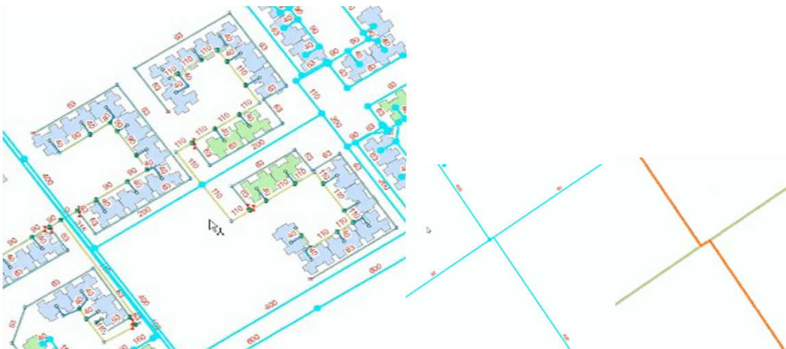
Figure V.112: correction de l'intersection de deux conduites
