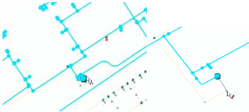
Figure V.113: connexion d'un tronçon du réseau au réservoir
