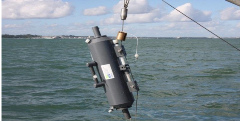
Figure : Présentation de la bouteille Niskin employée pour le prélèvement d'échantillons d'eau de mer.
