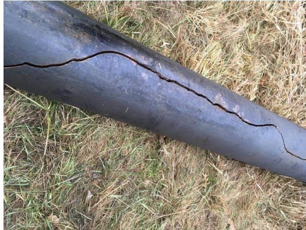
Figure I-6: Exemple réel d'une défaillance par fissuration longitudinale dans une conduite en PEHD
