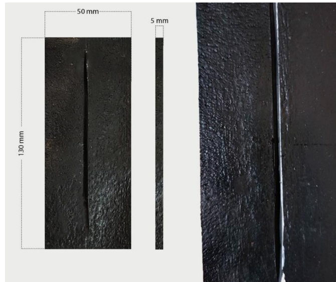
Figure III-1: Dimensions géométriques (en mm) des plaques en PEHD préparées pour le soudage
