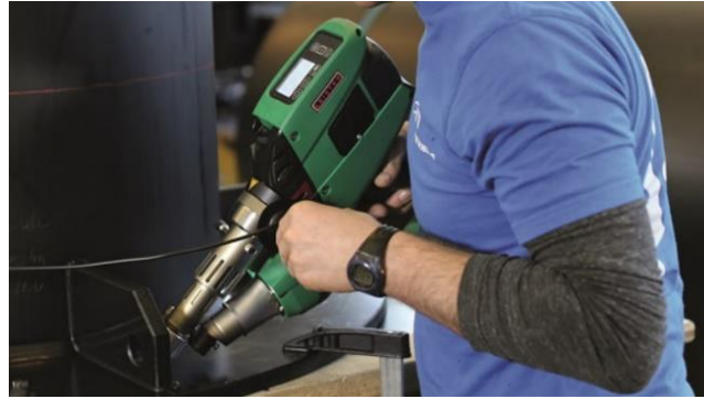
Figure I-19: le soudage par extrusion du polymères [44]
