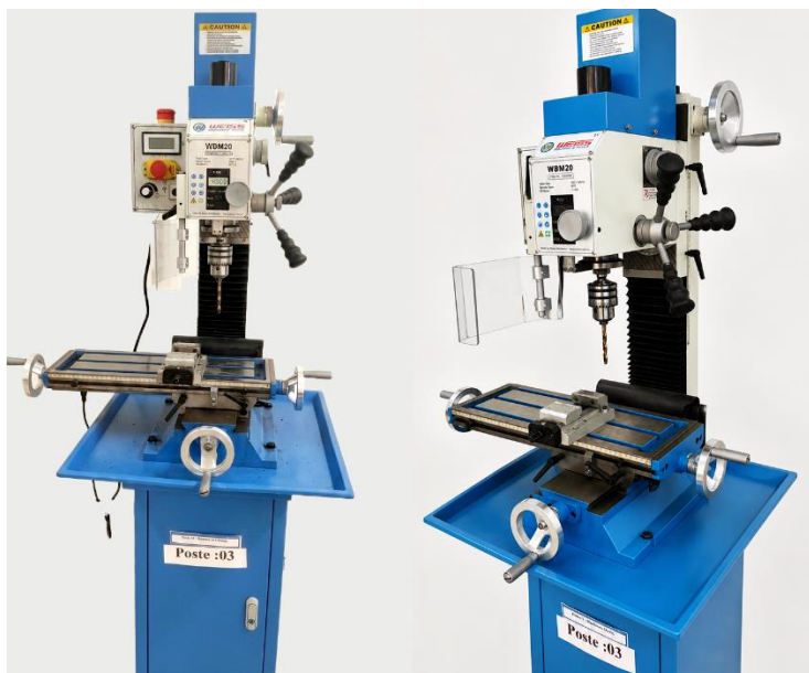
Figure III-2: Vue générale de la fraiseuse conventionnelle (WBM20) utilisée pour les essais FSW
