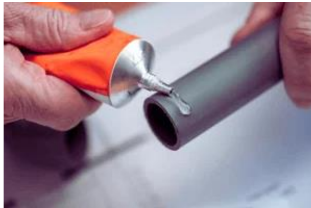
Figure I-20: Le collage par adhésifs (colles) [46]
