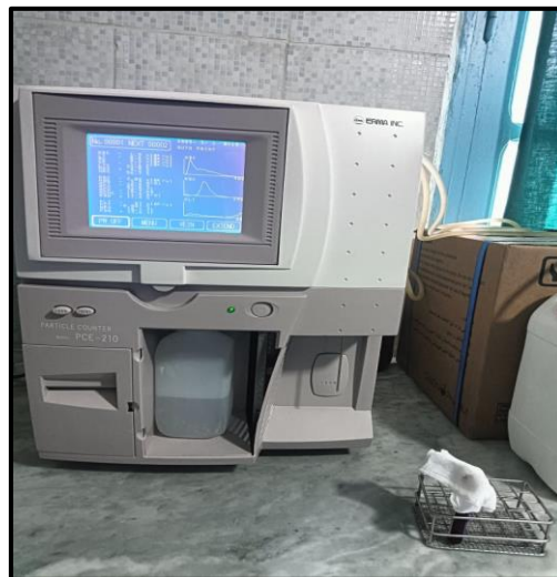
Figure 15 : Compteur de cellules sanguines automatique PCE-210N
