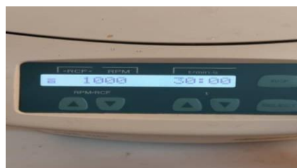
Figure 27: Test de centrifugation de la crème
