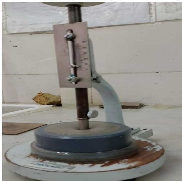
Figure II.24. Mesuré de la consistance normale
