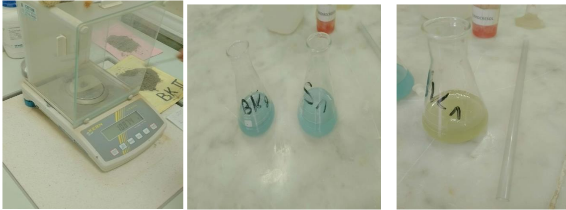
Figure II.13. Détermination de la chaux libre CaOL
