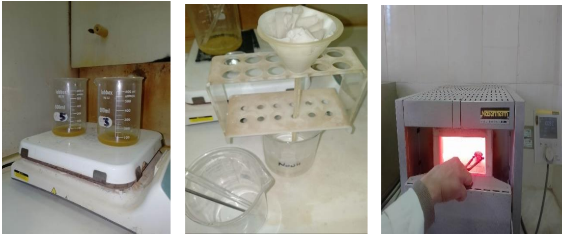
Figure II.15. Détermination du pourcentage de SO 3
