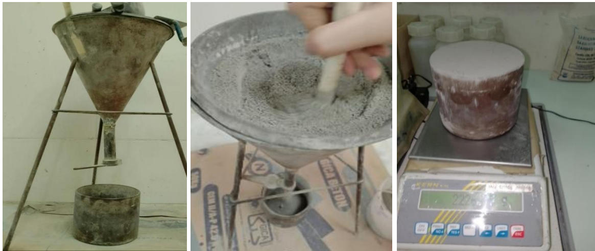
Figure II.20. Mesure de la densité
