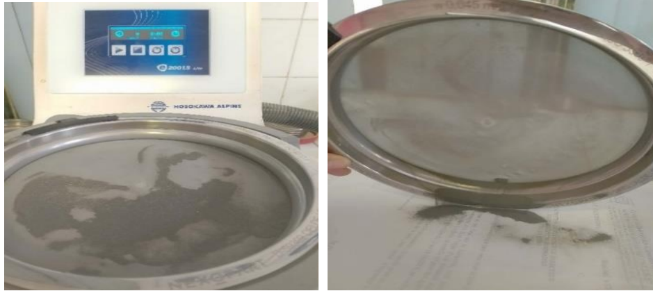
Figure II.4. Opération de tamisage du ciment sur le tamis de 45\ \mu\text{m}
