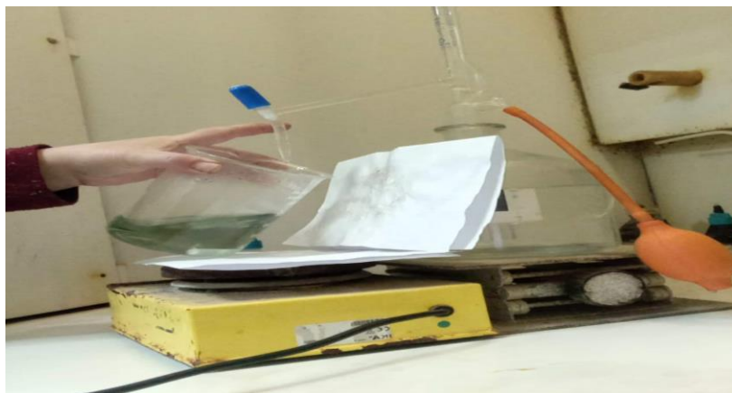
Figure II.10. Détermination de l'oxyde de magnésium (MgO)
