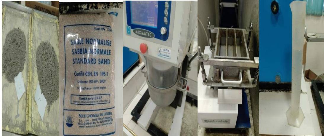
Figure II.32. Équipement pour préparation du Mortier
