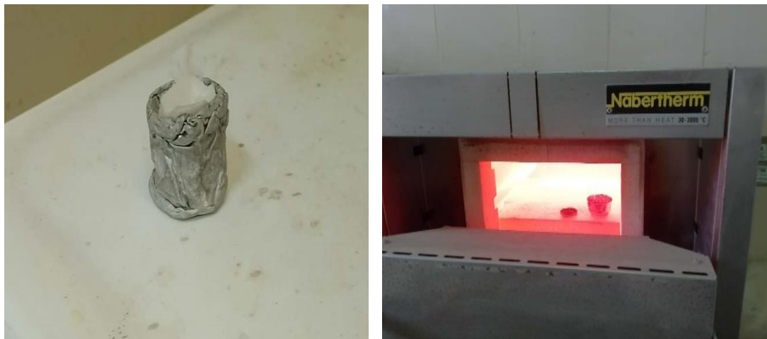
Figure II.9. Détermination de la silice (SiO 2 ) [9]
