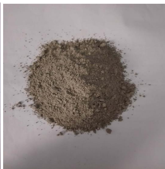
Figure IV.2. Ciment à 20% de Pouzzolane
