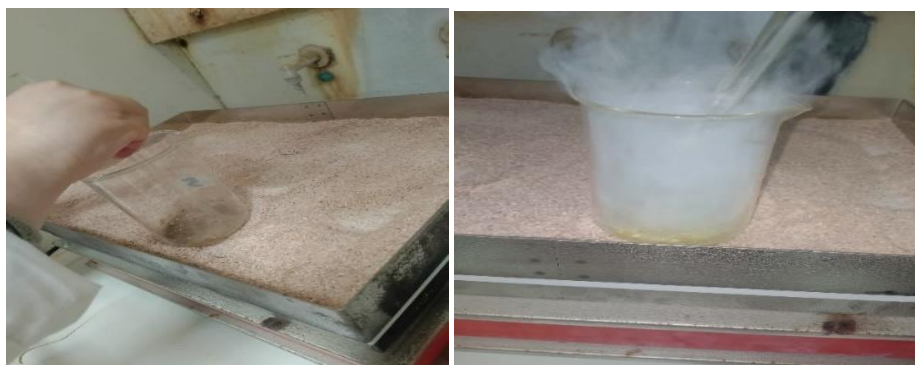
Figure II.6. Évaporation de la solution sur bain de sable
