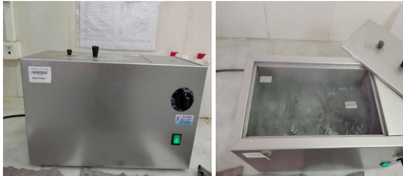
Figure II.30. Immerger le moule dans le bain-marie
