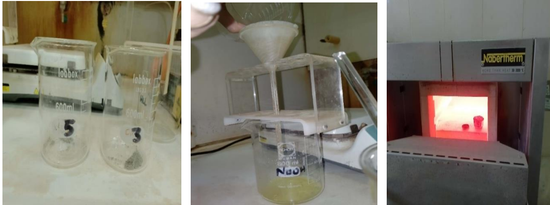
Figure II.16. Détermination des résidus insolubles EN 196-2[4][49]
