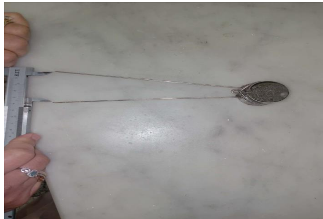
Figure II.31. Mesurer l'écartement final L_2
