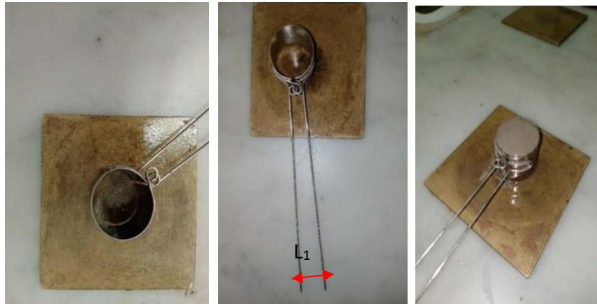
Figure II.28. Moule Le Chatelier remplie mesure L1
