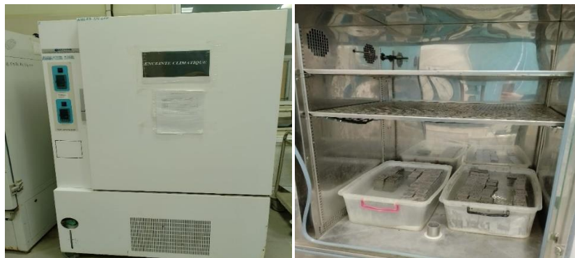
Figure II.29. Placer l'ensemble dans l'armoire humide
