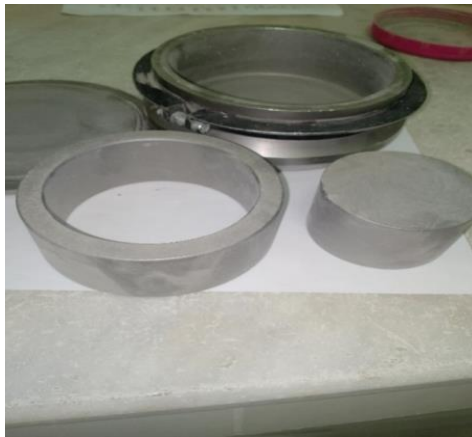
A : Pièces constituant le broyeur (HERZOG).
