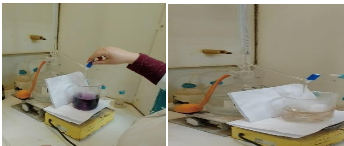
Figure II.11. Détermination de l'oxyde du fer \text{Fe}_2\text{O}_3
