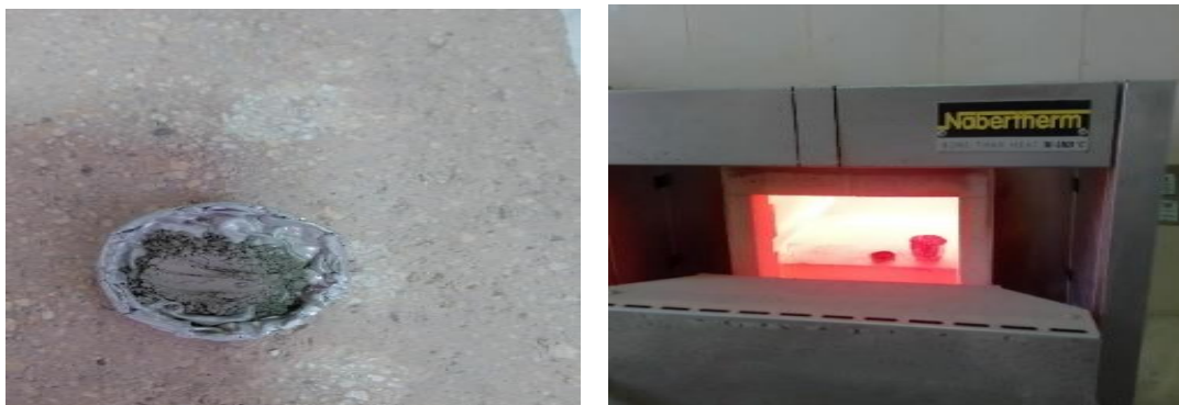
Figure II.14. Détermination de la perte au feu (PAF)
