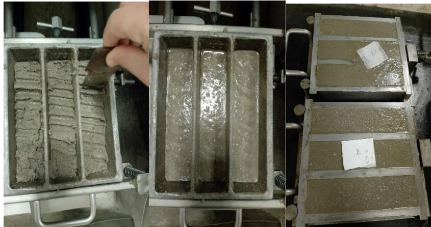
Figure II.34. Mise en moule et Compactage
