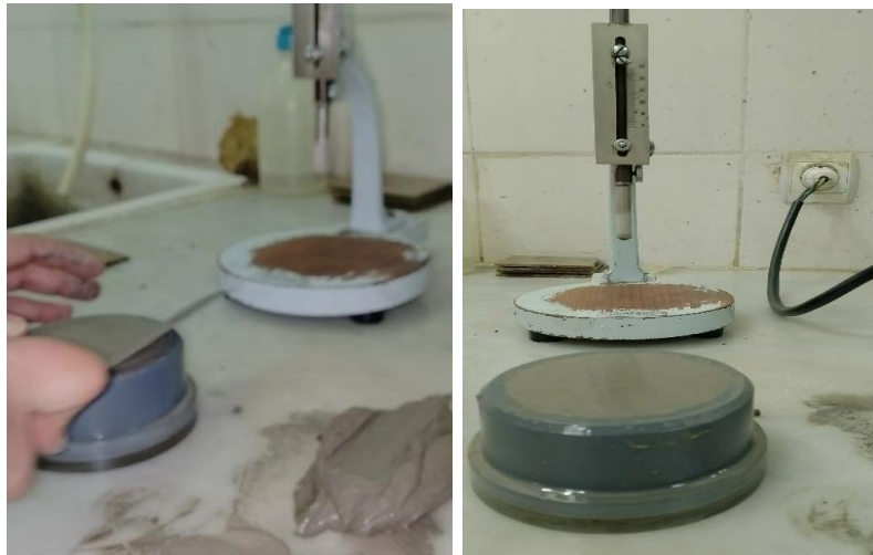
Figure II.23. Moule tronconique remplis de pâte
