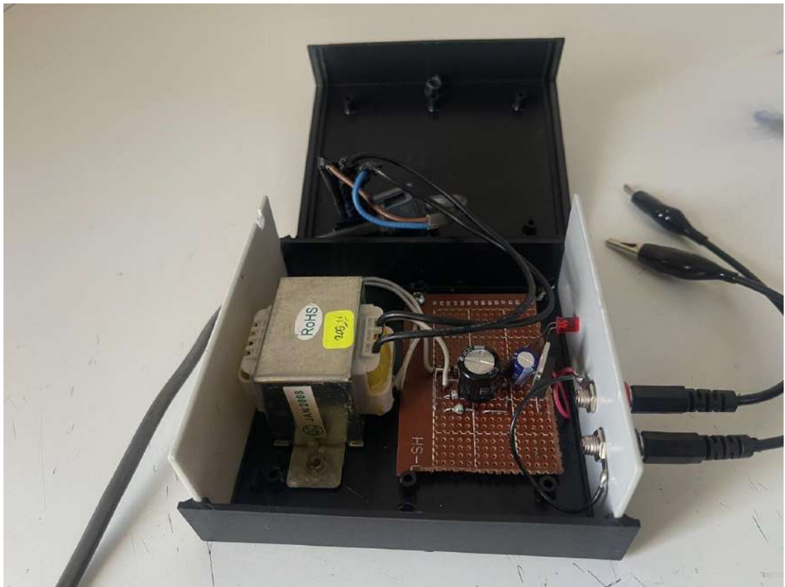
Figure (III.6) : Réalisation d'une alimentation stabilisée de 05V première partie
