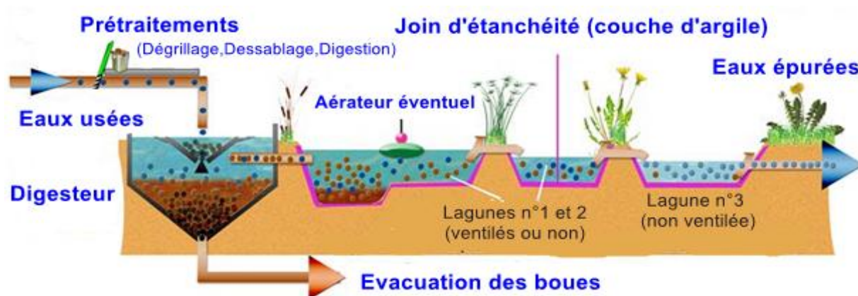
Figure II.2:Schéma de traitement des eaux usées par lagunage (bassins à microphytes).
