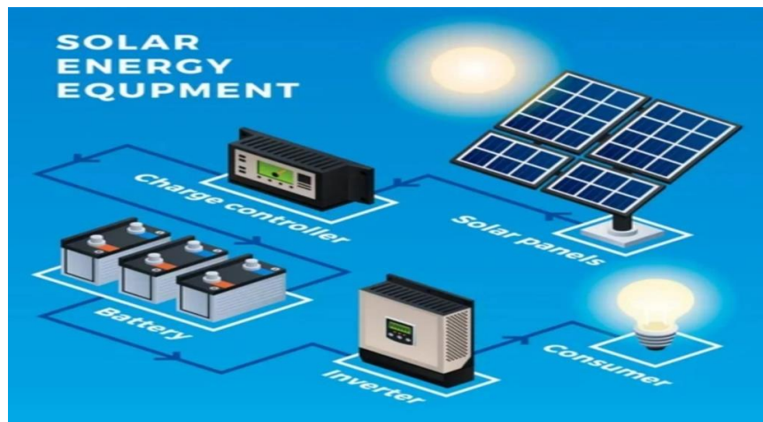
Figure (I.1): Exemple de mini-réseaux autonomes
