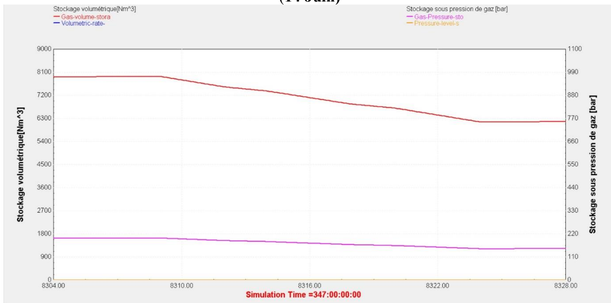
Figure (IV.6) : Variation de stockage de gaz en volume et à débit volumétrique, et de stockage de gaz sous pression et sous niveau de pression durant les jours (14 Juin) et de (14-Décembre).
