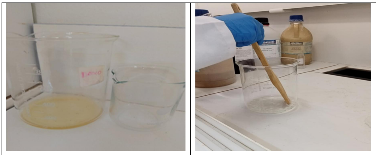
Figure 7 : Préparation de la solution de soude.
