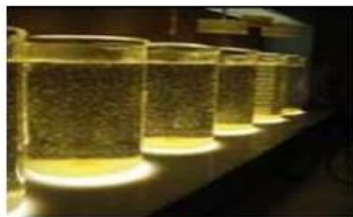
Figure II-11 : Essai de coagulation dans une usine de traitement [53]
