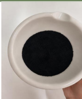
Figure III. 6: Le charbon actif produit à partir de noyaux de dattes (CAND).
