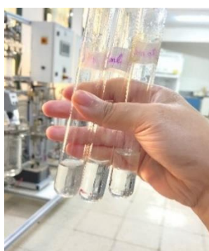
Figure III. 13 : Adsorption du bleu patenté V par le charbon actif issu de noyaux des dattes
