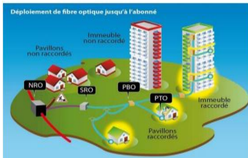
Figure II.1 : Structure d'un réseau FTTH.
