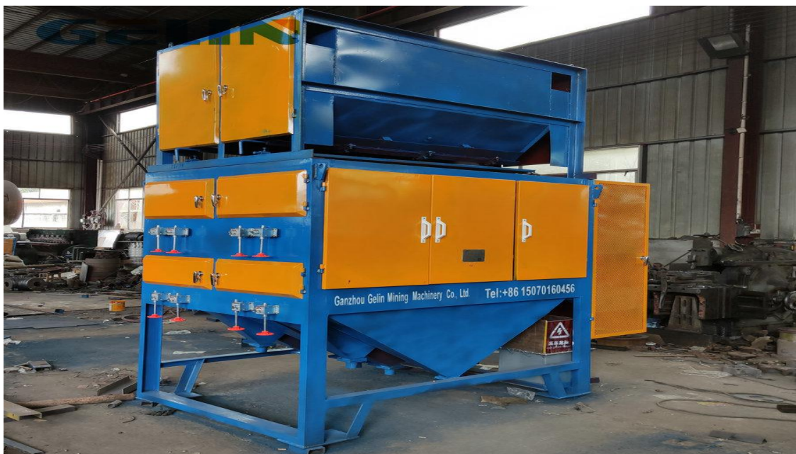
Figure II.7 : Séparateur électrostatique haute tension. [28]
