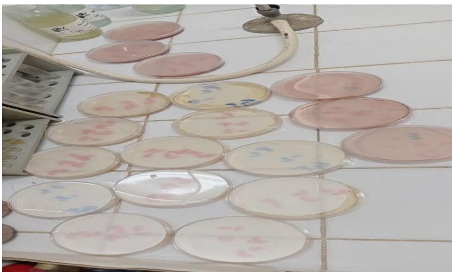
Figure N°10: Boîtes de Pétriensemencées pour les germes totaux et les coliformes fécaux lors de la solidification du milieu.(photo originale ).
