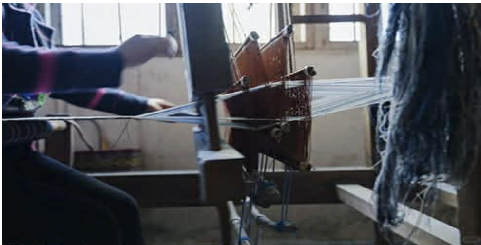
Figure 9: Mise en place des files de chaine sur le métier à tisser [17]
