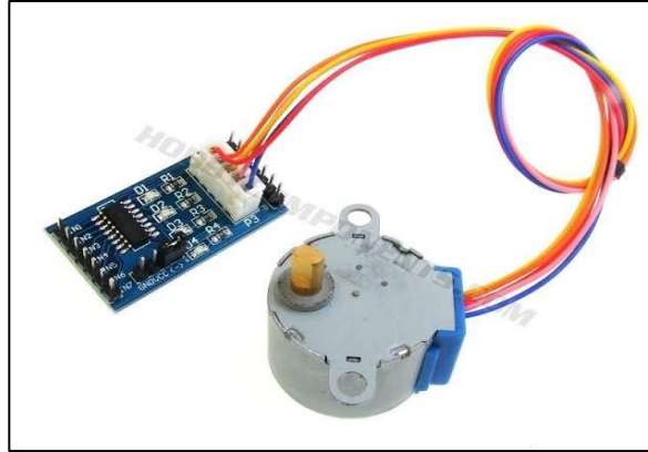
Figure 22: Moteur pas à pas avec sa carte de commande ULN2003 [42]
