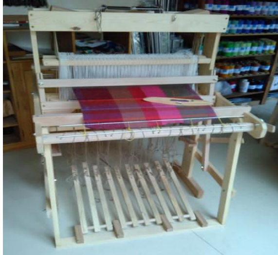
Figure 3: Structure d'un métier à tisser manuel illustrant les éléments du cycle mécanique (Pédales, Navette et Battant) [14]
