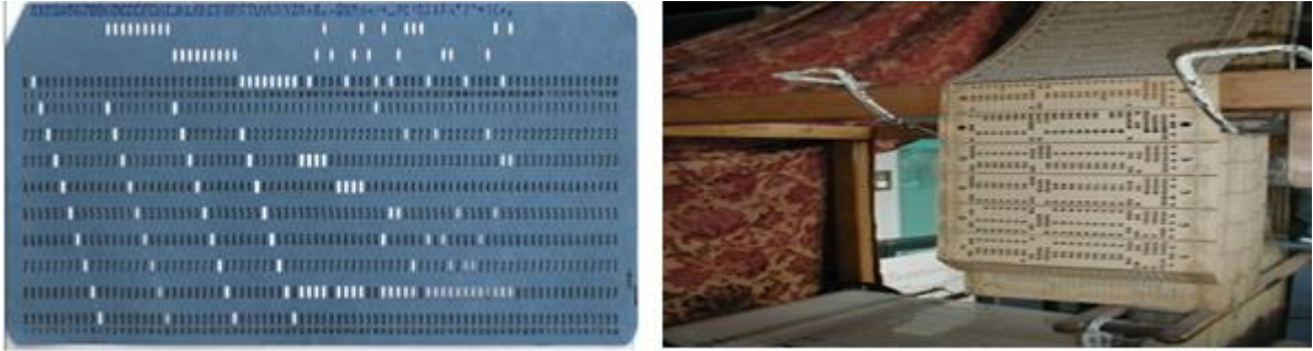
Figure 11 : Les éléments de Commande du Mécanisme Jacquard (Carte et Cylindre) [19]
