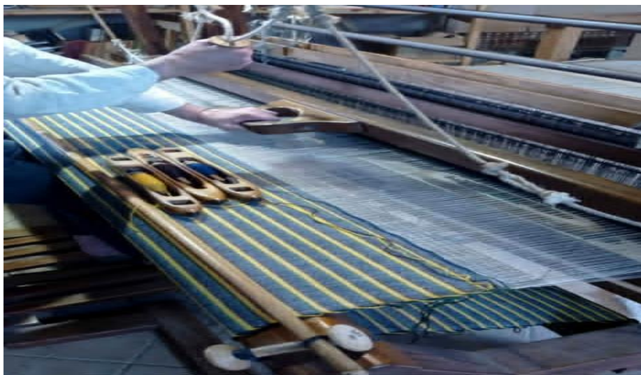
Figure 10: Vue Détaillée du Processus de Tissage (La Trame) [17]
