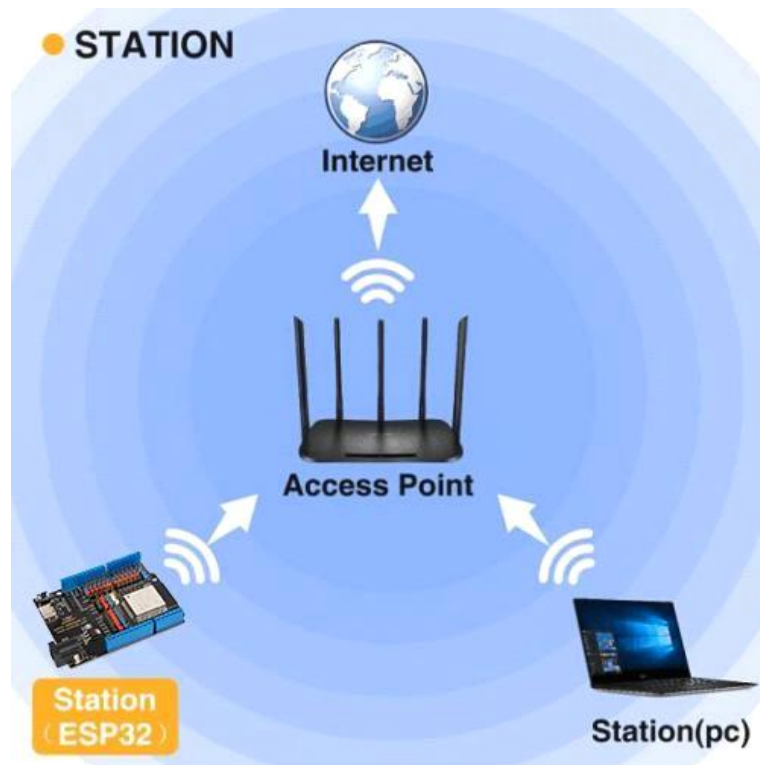
Figure III.12. Schéma de connexion réseau de l'ESP32 : modes Station (STA) et Point d'Accès (AP)
