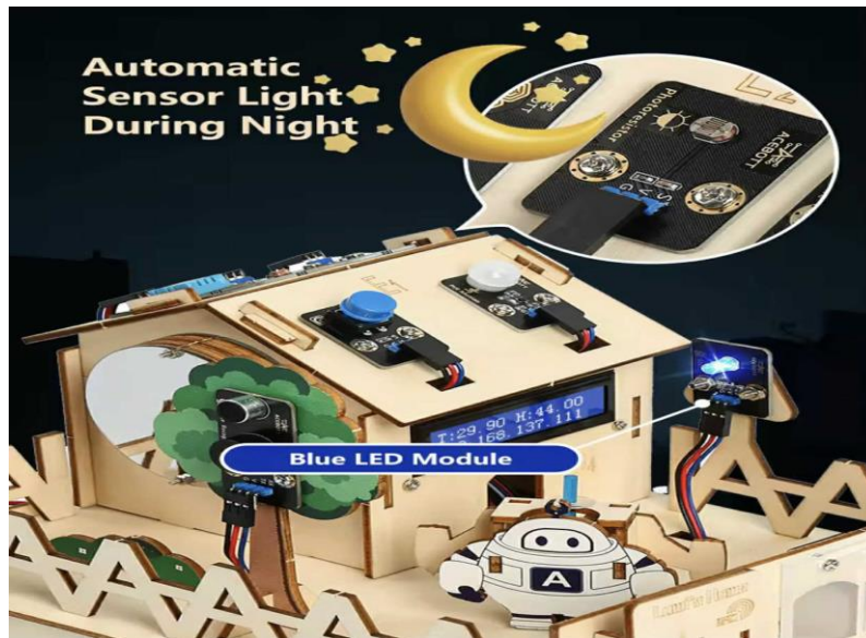
Figure III.5. Réaction du système Lumi en cas de détection de présence la nuit.
