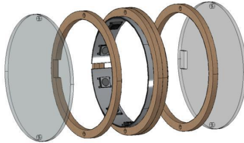
Figure II.27. Intégration du module RGB à l'intérieur du miroir intelligent
