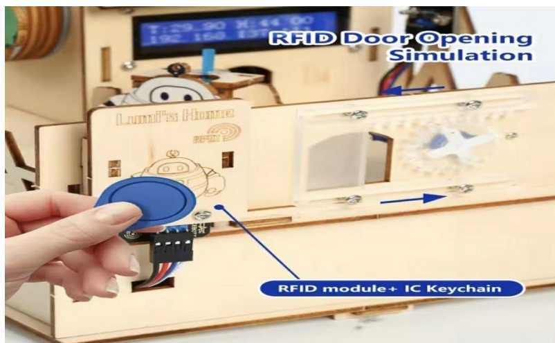
Figure III.7. Réaction d'Ouverture automatique d'une porte via un capteur RFID du système Lumi
