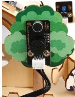
Figure.II.14. Module de reconnaissance vocale connecté à l'ESP32.
