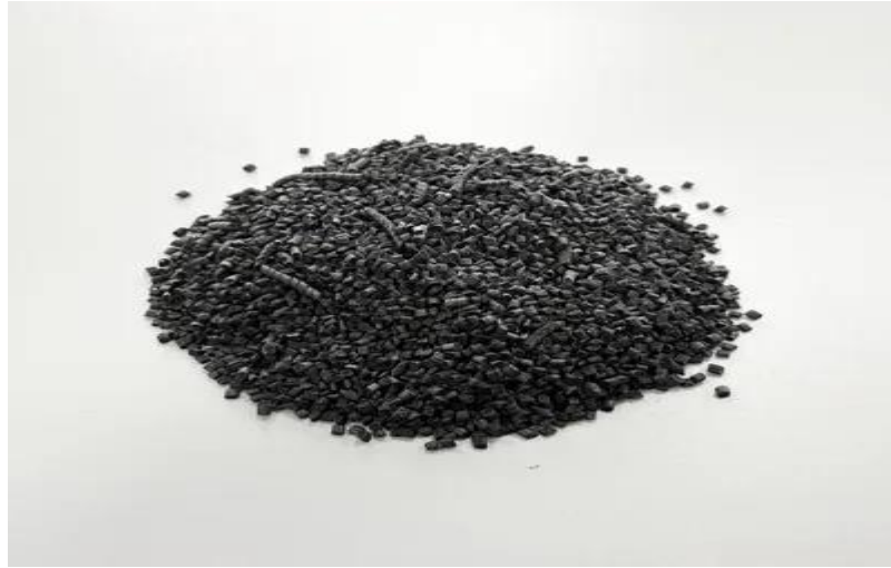
Figure 8 :Matériaux micro-encapsulés qui respecte l'environnement de changement de phase de PCM pour le cycle de l'eau[38].
