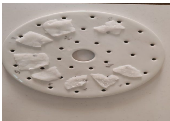
Figure 19: tranches de masse \approx 0.5 g destinées au test d'humidité via le dessiccateur
