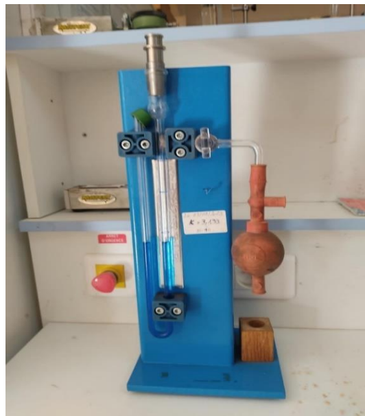
Figure 2.19 : Perméabilimètre de Blaine.
