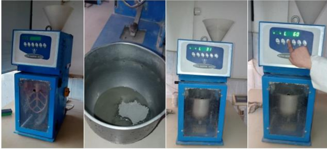
Figure 2.25 : Les étapes du malaxage du mortier.
