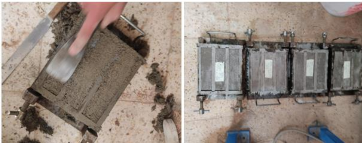
Figure 2.27 : Remplissage d'éprouvettes prismatiques (4x4x16) cm 3 .
