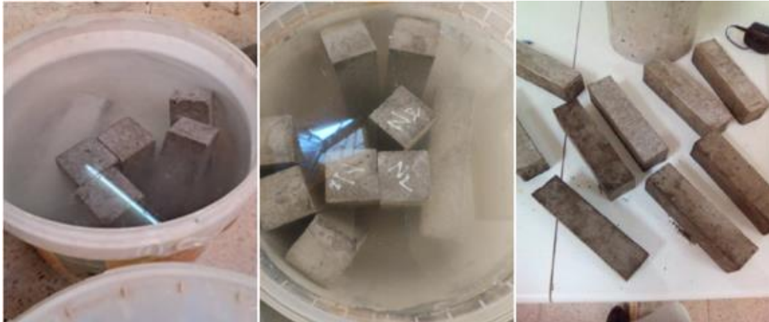
Figure 2.28 : Les éprouvettes après démoulage et conservation.
