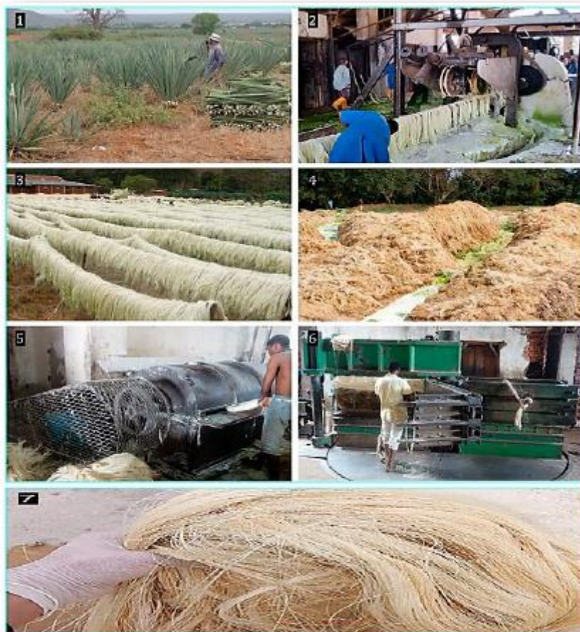
Figure 1.10 : Processus principales de production des fibres de sisal. [83].
