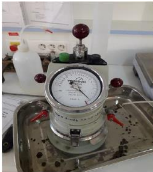
Figure 2.31 : Appareil de mesure de la teneur en air occlus.
