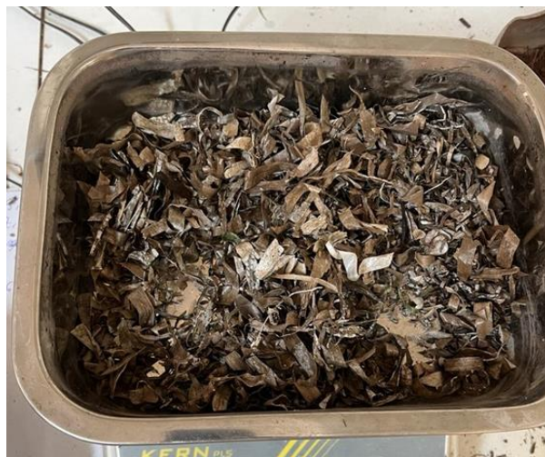
Figure 2.9 : Fibres des algues après la collecte et séchage.
