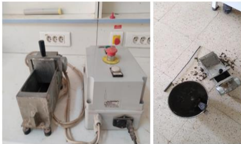
Figure 2.30 : Maniabilimètre de mortier.
