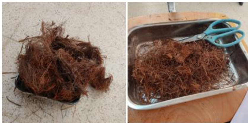
Figure 2.20 : fibres dattier après lavage et coupe.
