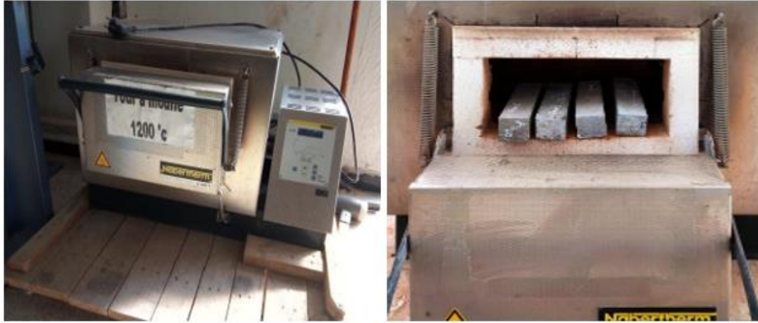
Figure 2.32 : Four utilisé pour le chauffage des éprouvettes à température maximale 1200 °C.
