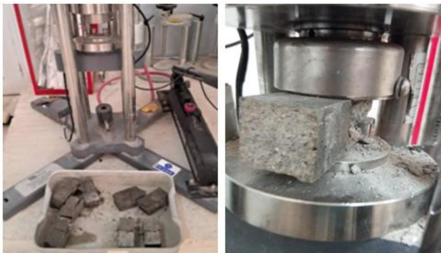
Figure 2.36 : Essai de résistance à la compression.
