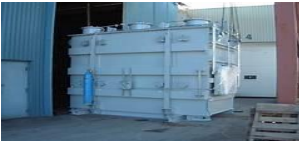
Figure 1.10: Cuve de transformateur
