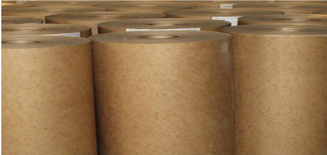
Figure 1.12 : Papier Presspahn d'isolation électrique [44]
