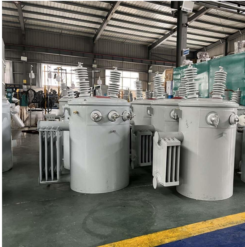
Figure 1.6 : Transformateur monophasé abaisseur
