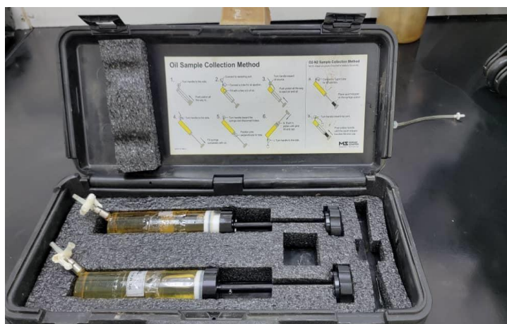
Figure 2.10 : Kit de prélèvement d'échantillons d'huile isolante au laboratoire de Sonelgaz.
