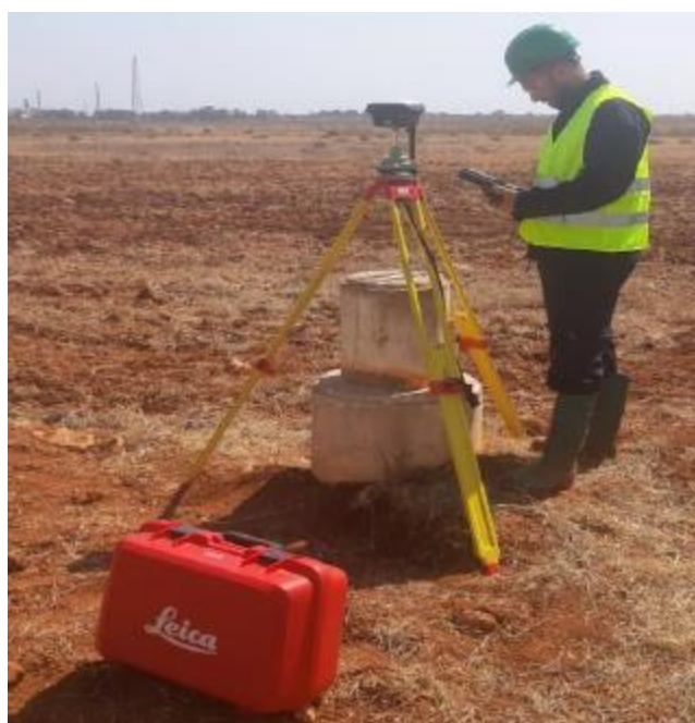
Figure 3 Matériel de levé topographique : station totale Leica TS06+.
