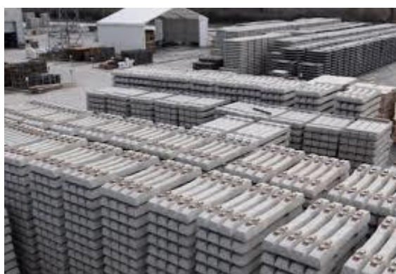
Figure 54 : Parc de stockage industriel de traverses en béton précontraint sur site de préfabrication
