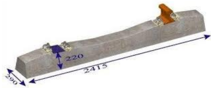
Figure 41 Dimensions Géométriques D'une Traverse En Béton Monobloc
