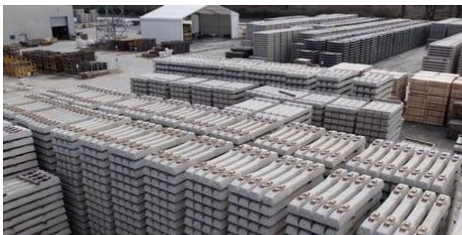
Figure 39 Stockage Industriel De Traverses En Béton Bi-Bloc Sur Le Site De Préfabrication
