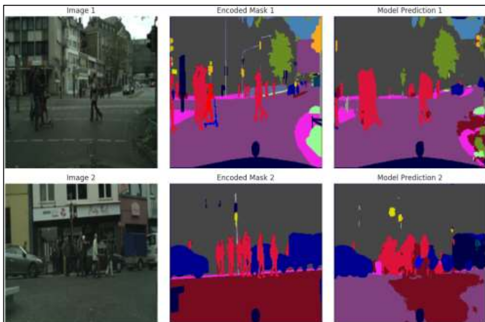
Figure III-17 : Exemples de segmentation sur des images de test (de gauche à droite image originale, masque réel, prédiction du modèle).
