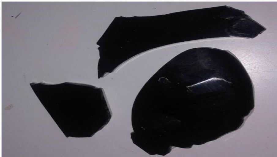
Fig.4-8 Vitrification de la vase à 1300°C
