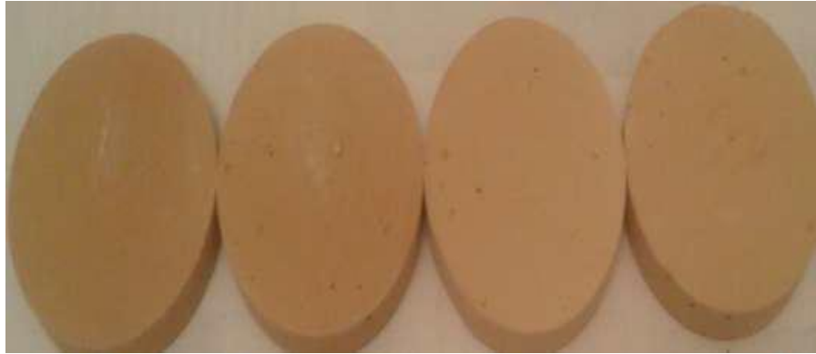
Fig.4-20 Température de cuisson de la Vase du Barrage de Bouhanifia à (900 ° C, 950 ° C, 1000 ° C et 1050 ° C)
