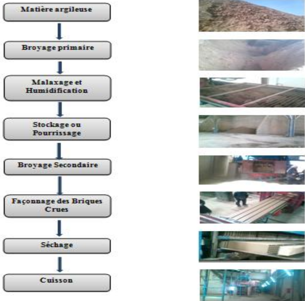
Fig.4-18 Processus de Fabrication de la Brique Rouge (Briqueterie de Zemmoura- Relizane)
