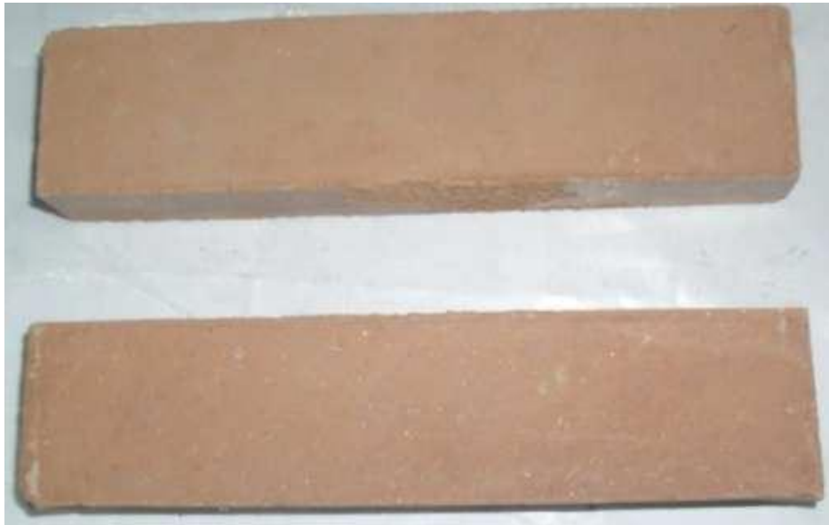
Fig.4-25 Briques prismatiques cuites à 850 °C
