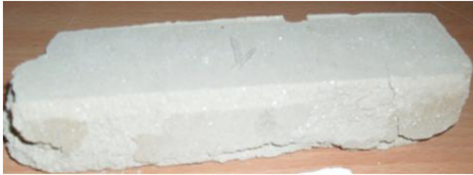
Fig.4-16 Brique pressée et auto clavée avec activateur (7% d'eau et 4% de la chaux)
