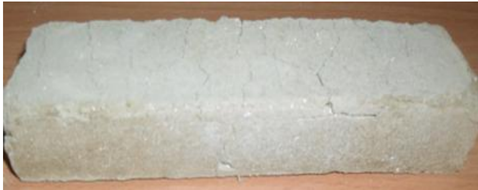
Fig.4-17 Brique pressée et auto clavée avec activateur (10% d'eau et 4% de la chaux)
