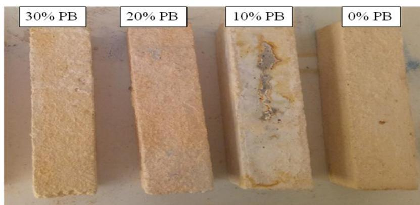
**Fig.9.** Echantillons de différents mortiers avec un rapport E/L égal à 0.5, après 10 jours d'immersion dans la solution d'acide sulfurique ( $H_2SO_4$ ).
