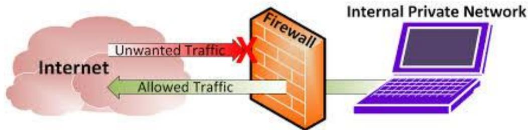
Figure 5.1 – Principe de fonctionnement d'un firewall
