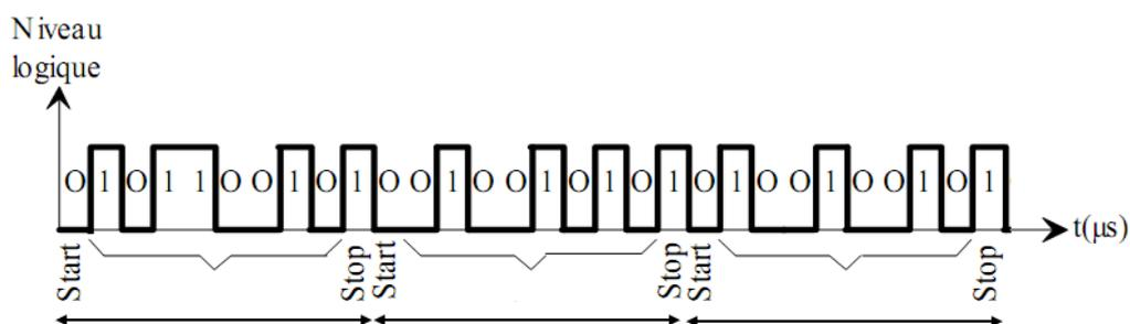
Figure II. 8 : Transmission asynchrone
