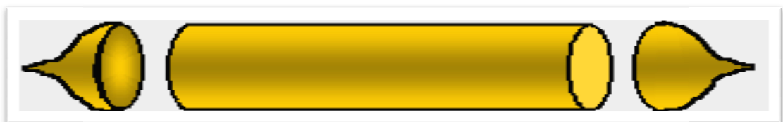
Figure I. 8 : Équeutage du lingot [11].
