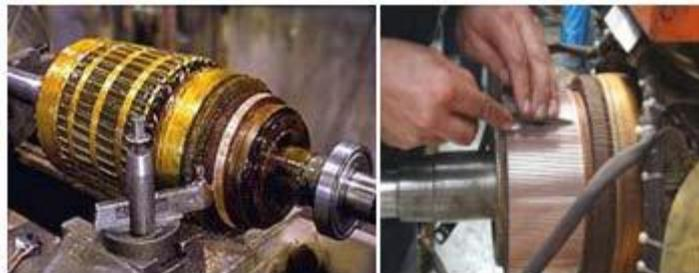
*Figure I.3: Le rotor de la machine à courant continu*
